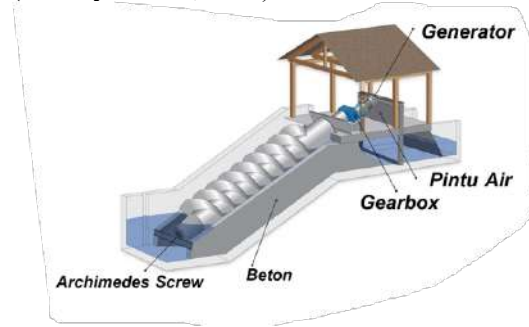
Gambar 2. Cara Kerja PLTMH Sumber : (ALizarrrd, 2021)
