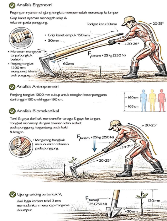
Gambar 13 analisis ergonomic tongkat tanam mangrove
